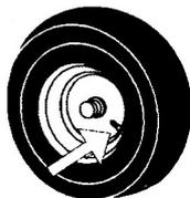
Регулярно проверяйте давление в шинах. Давление должно составлять 1 бар (0,1 МПа или 14 PSI) и 0.8 бар (0,08 МПа или 12 PSI) соответственно в передних и задних шинах.
