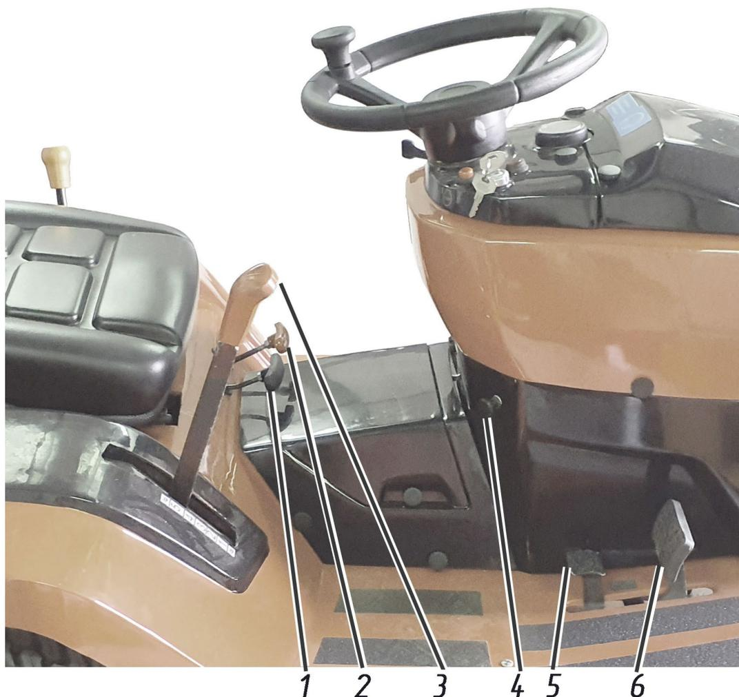
Рисунок 3.1а – Расположение органов управления газонокосилки
